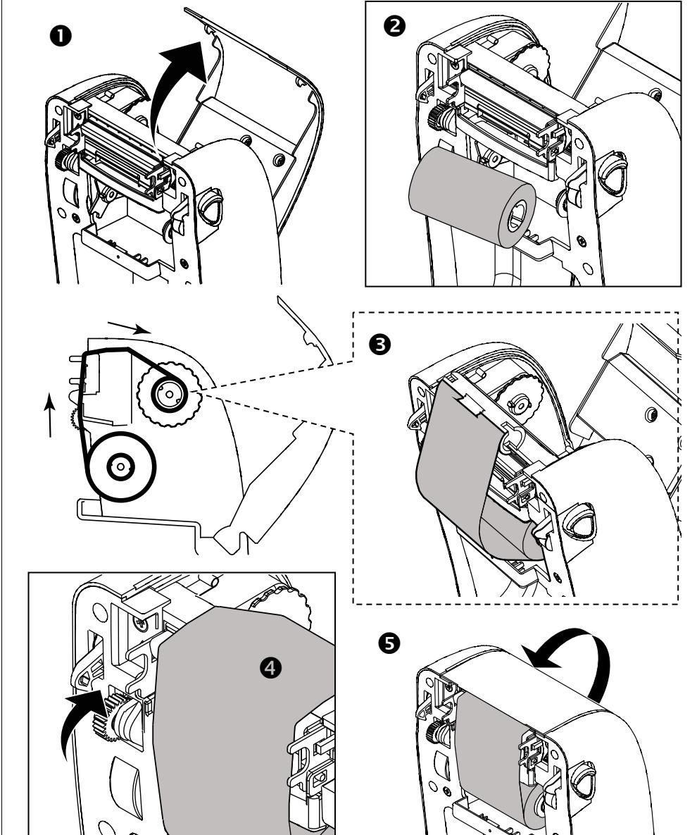
Loading Media/安装標籤/安装标签/メディアの読み込み/Загрузка носителя/ Medien werden geladen/Chargement des medias/Cargando medios/Caricamento dei media/ تحميل الوسائط
