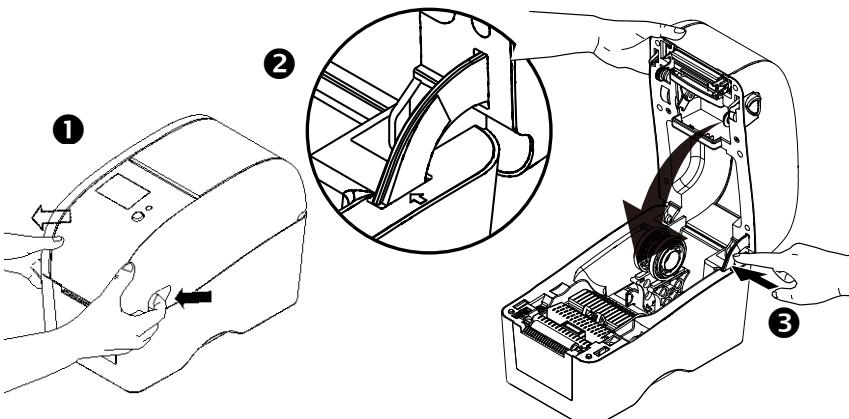
Loading Ribbon/安装碳带/安装碳带/ローディングリボン/Загрузочная лента/
